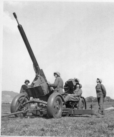
Diese 34-mm-Flakkanone schweizerischer Fabrikation (Waffenfabrik Bern) konnte 250 Schuss pro Minute abfeuern.
